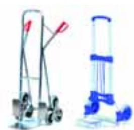
Figura 125 – Carretillas ligeras, la primera con ruedas para subir o bajar escalones.
