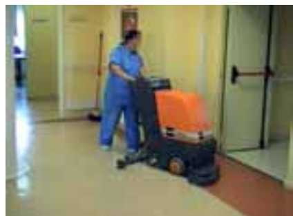
Figura 106 – La utilización de herramientas motorizadas puede reducir la fuerza y la repetitividad, además de incrementar la eficiencia.
